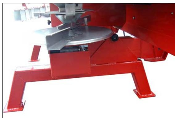
**PARK THE FERTILIZER SPREADER ONLY WITH THE HOPPER EMPTY AND ONLY ON SOLID, LEVEL GROUND. ALWAYS USE THE SUPPORT FEET PROVIDED.**
